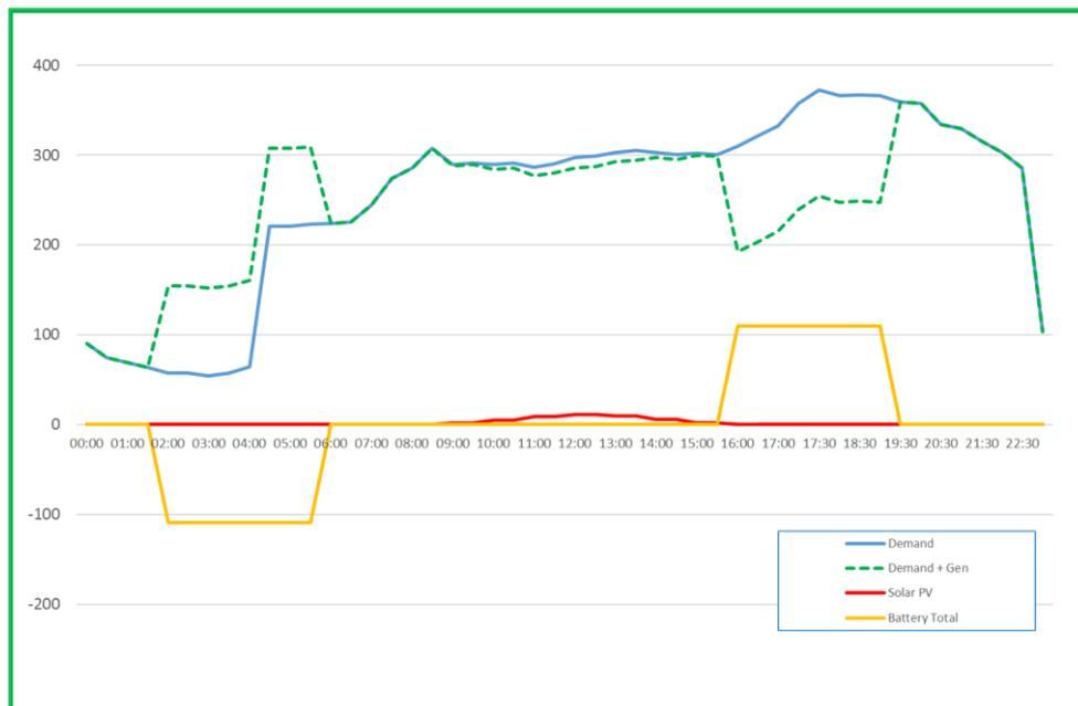
**FIGURE 11 – WINTER DIURNAL DEMAND PROFILE AT THE DISTRIBUTION SUBSTATION**
