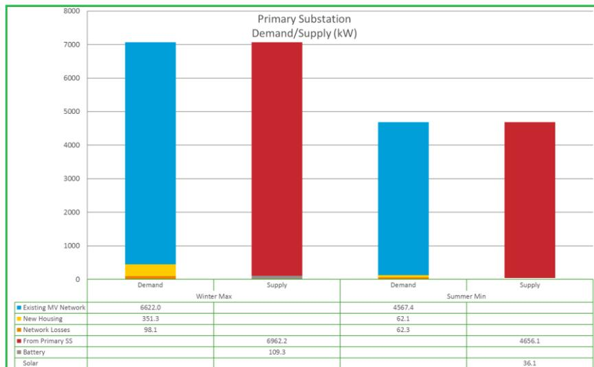
**FIGURE 4 – WINTER MAXIMUM AND SUMMER MINIMUM POWER DEMAND (kW) AT THE PRIMARY SUBSTATION**
