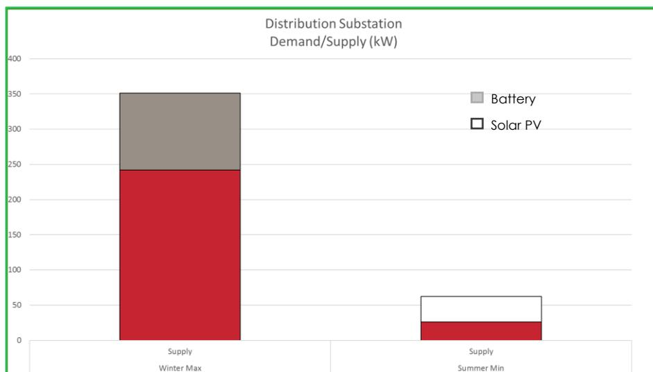
FIGURE 10 – WINTER MAXIMUM AND SUMMER MINIMUM POWER DEMAND (kW) ON THE DISTRIBUTION SUBSTATION
