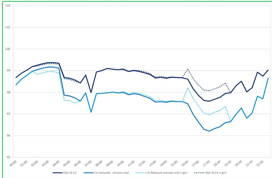
**FIGURE 16 – WINTER MAXIMUM DIURNAL VOLTAGE PROFILE ON THE LV NETWORK**
