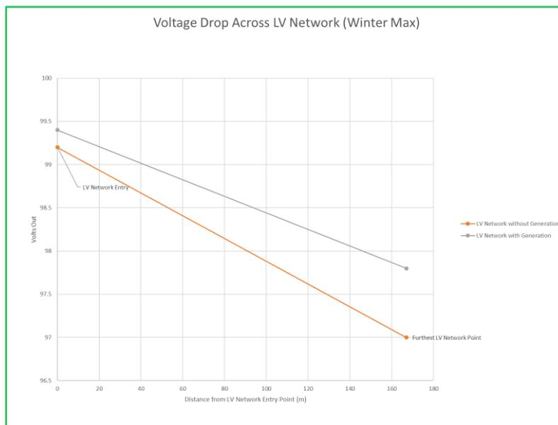
**FIGURE 15 – WINTER MAXIMUM VOLTAGE PROFILE ON THE LV NETWORK**
