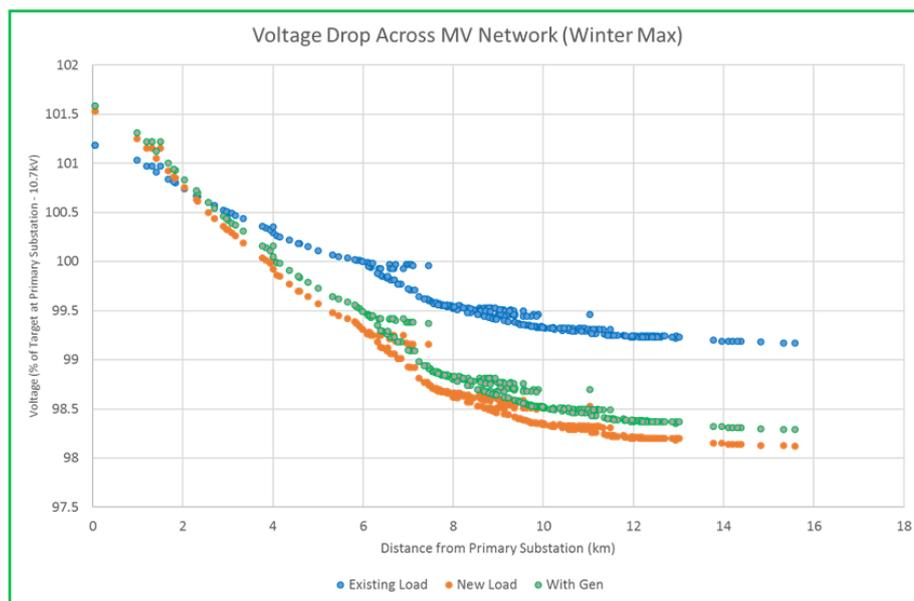
**FIGURE 13 – WINTER MAXIMUM VOLTAGE PROFILE ON THE MV FEEDER**
