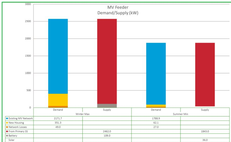
**FIGURE 7 – WINTER MAXIMUM AND SUMMER MINIMUM POWER DEMAND (kW) ON THE MV FEEDER**
