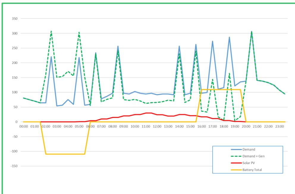
**FIGURE 12 – SUMMER DIURNAL DEMAND PROFILE AT THE DISTRIBUTION SUBSTATION**
