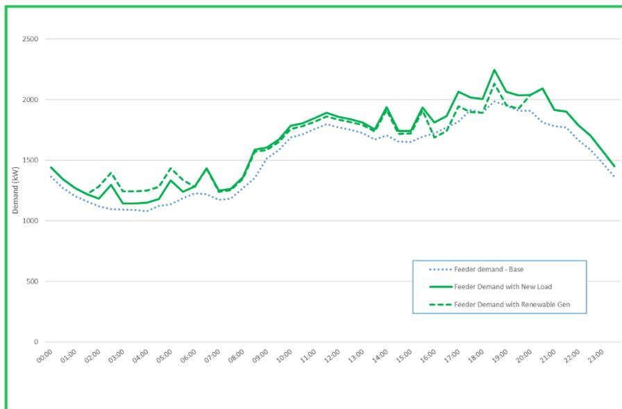
**FIGURE 9 – SUMMER DIURNAL DEMAND PROFILE AT THE MV FEEDER CIRCUIT**
