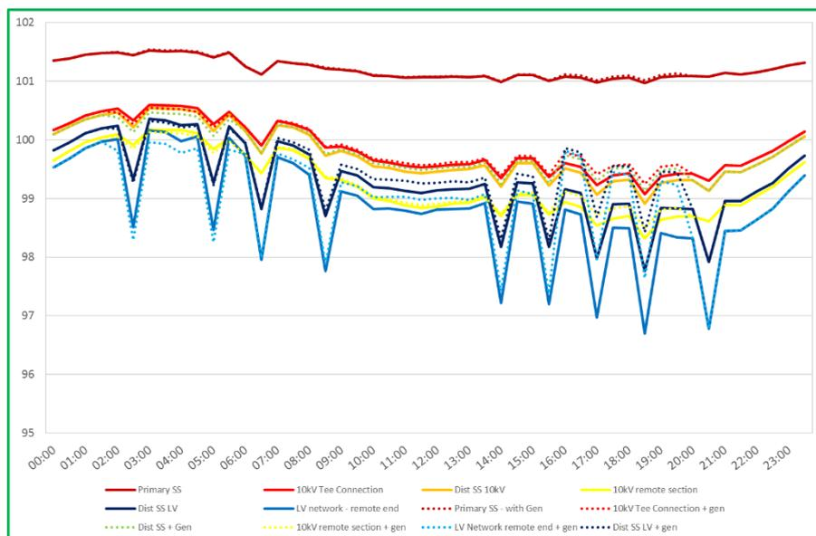
**FIGURE 17 – SUMMER MINIMUM DIURNAL VOLTAGE PROFILE ON THE LV NETWORK**
